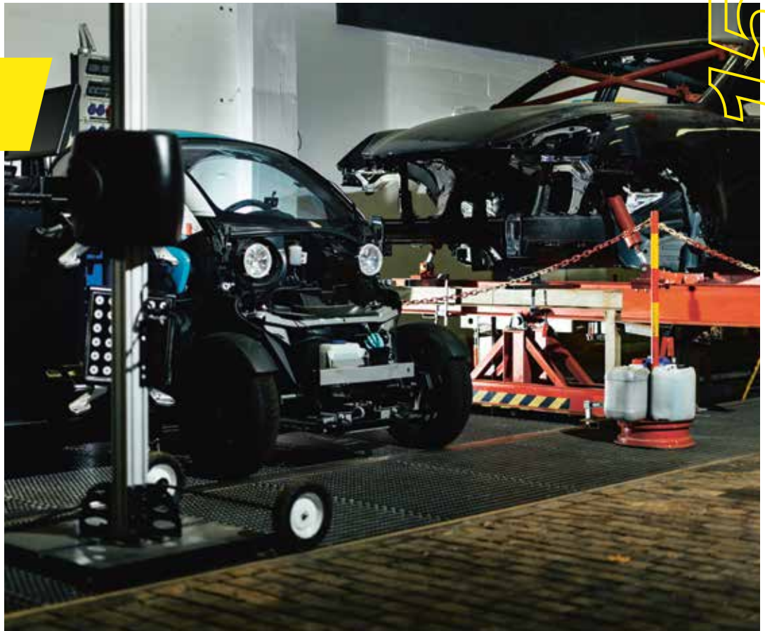
Der kleine Renault Twizy fährt elektrisch und wird vor allem für Fahrdynamikuntersuchungen genutzt. Weil er so schön offen ist, lässt sich am Fahrwerk recht schnell etwas verändern.
