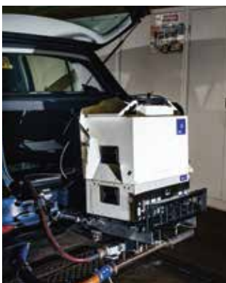
Abgasmessung. Das Gerät erinnert optisch an einen Kühlschrank, ist aber teurer als das Fahrzeug, das getestet wird.
